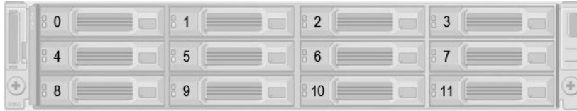
Ilustración 13. Numeración de unidades de la Gabinete de expansión SC100
