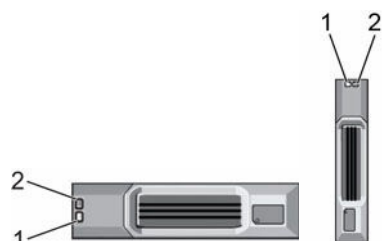
Ilustración 5. Indicadores de las unidades del Gabinete de expansión SC100/SC120
